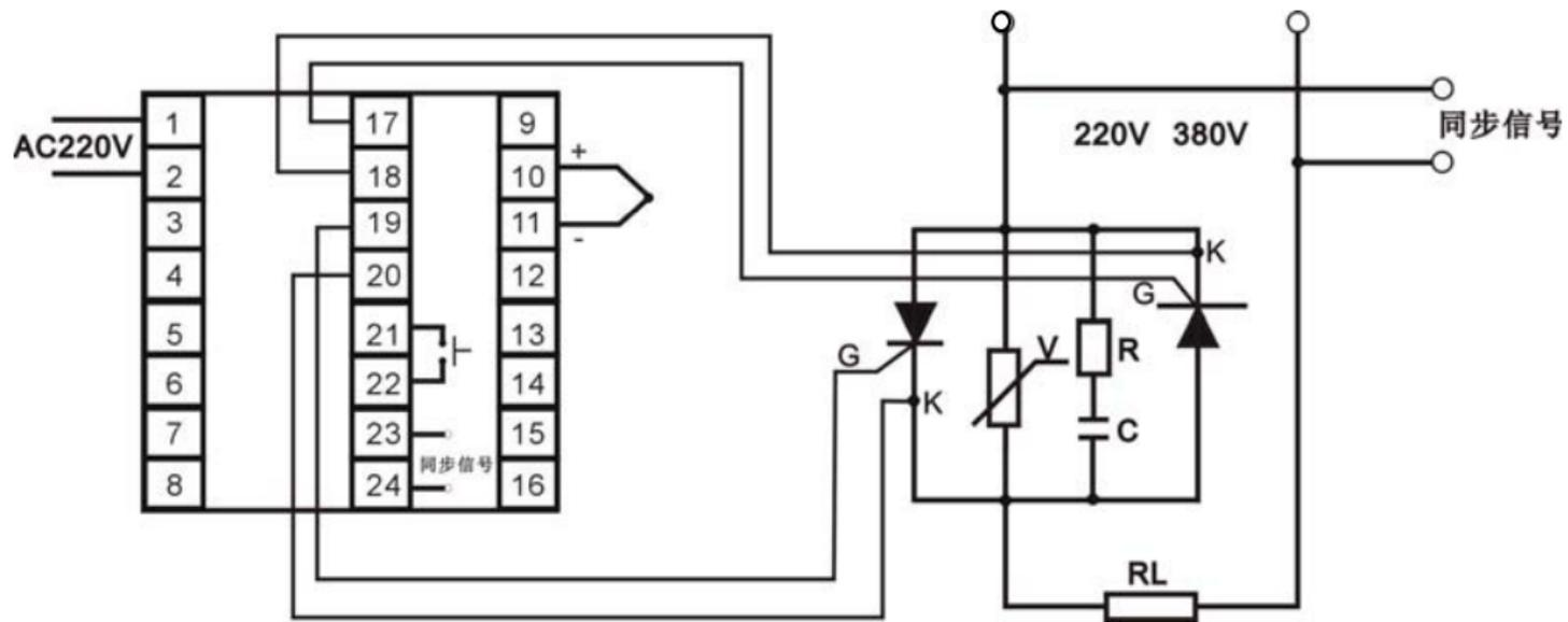
图 6.8 接单向可控硅反并联
