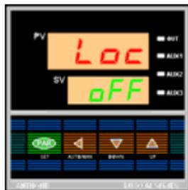
按 **PAR** 键 3 秒钟放开, 进入参数设定状态, 上显示窗 (PV) 显示第一个参数“Loc”符号, 下显示窗 (SV) 显示该参数当前值。可通过按“▲”“▼”键修改闪烁位的数值。
