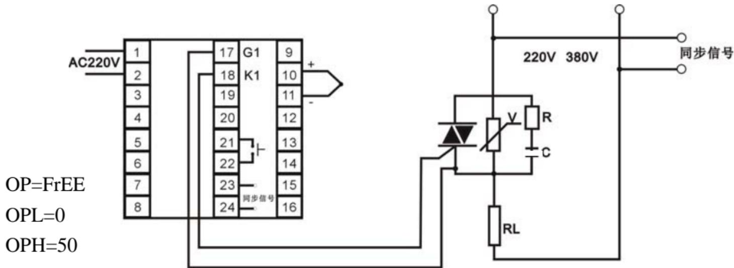
注：仪表的内部工作原理为，仪表内部输出0-5V（1-5V）的电压给C1(C3、C4)移相触发板，当仪表输出0V电压时，C1(C3、C4)移相触发板输出完全关闭，当仪表输出5V电压时，C1(C3、C4)移相触发板完全打开。
