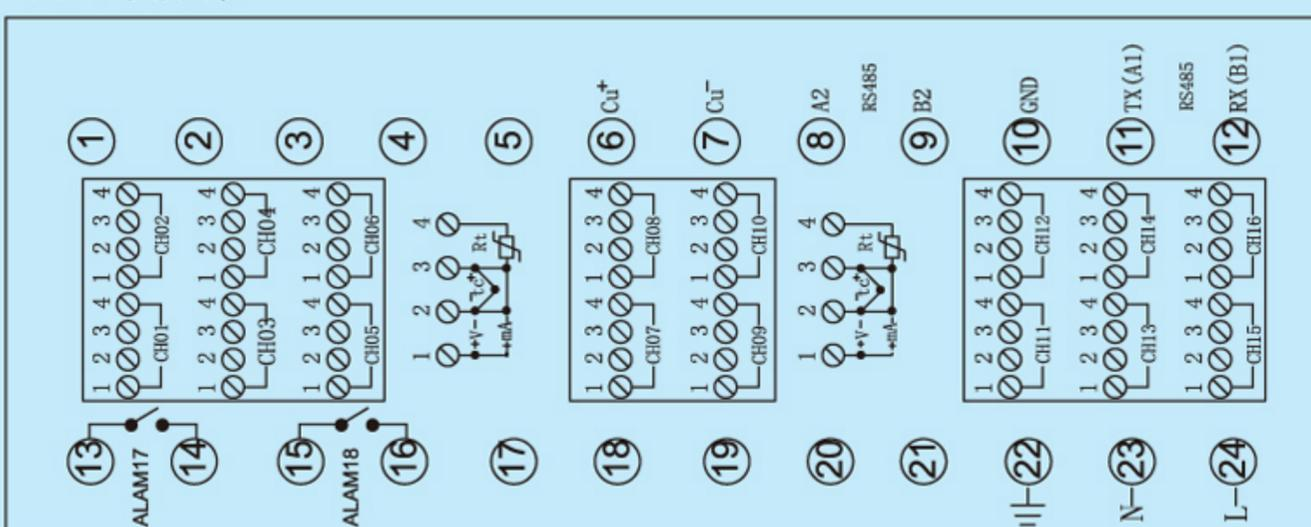
注: RC为热电阻和电阻、TC为热电偶、mA为电流信号、V为电压信号。
