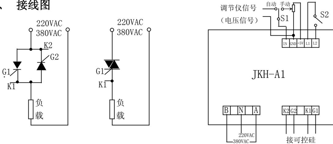
说明：开关 S2 断开时，有脉冲输出；开关 S2 闭合时，封存锁脉冲。不用时开关 S2 不用装。
