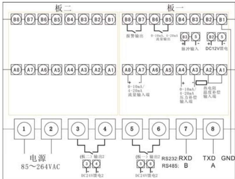
图1.4.3.3 板型50M的接线图
