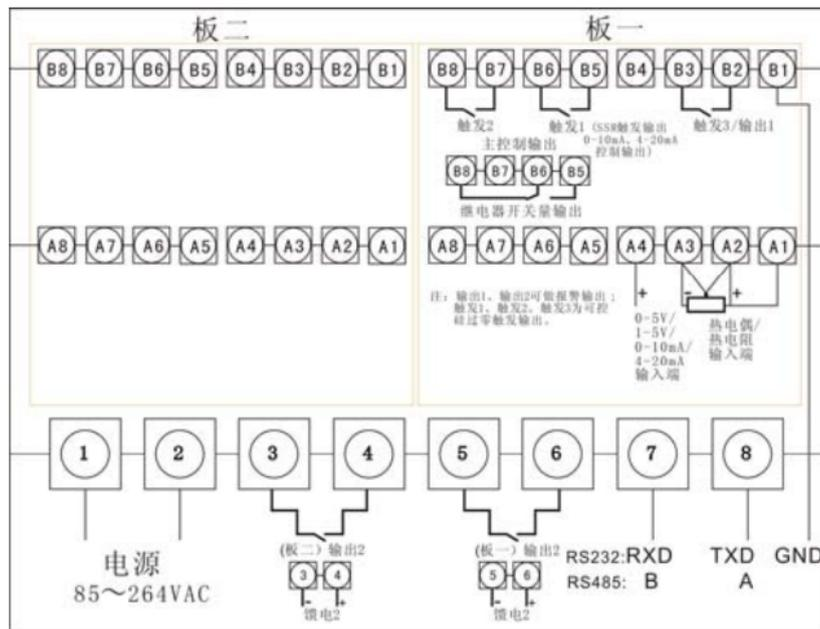
图1.4.3.2 板型906M、960M的接线图
